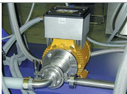
YTRON-Z con convertidor variador de frecuencia
