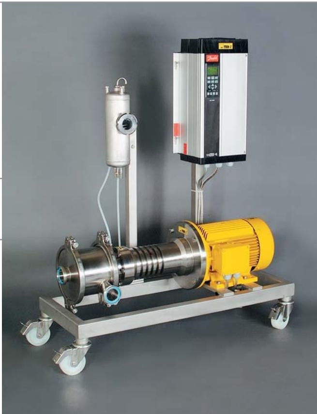
YTRON-Z móvil con variador de frecuencia
